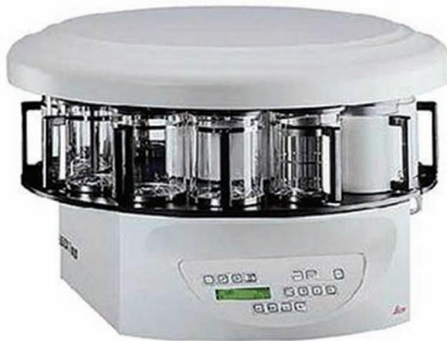
*Слика 4. Ткивни процесор компаније Leica-циклис обраде ткива 18-20 сати.*
